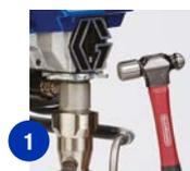
1 Die Spannmutter lösen
