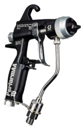
PerformAA Airless-Pistolen sind mit 105 bar (1.500 psi) für Anwendungen mit niedriger Viskosität und 345 bar (5.000 psi) für das Spritzen mit hohem Druck erhältlich.
