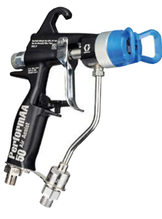
Die luftunterstützte Pistole PerformAA 50 spritzt mit 345 bar (5.000 psi) für Top-Leistung bei hohem Druck.
