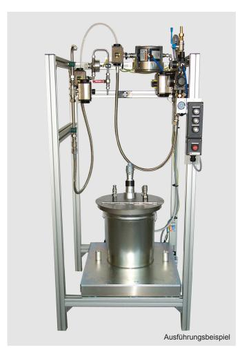
Farbversorgungssystem mit Rückgewinnung des Lackmaterials von der Farbstation und der Ringleitung beim Farbwechsel über Kugelhahnverschaltung.
