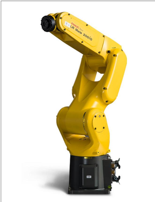
Der FANUC LR Mate 200iD ist ein kompakter 6-Achsen-Roboter mit der ungefähren Länge und Reichweite eines menschlichen Arms. Er kombiniert ein erstklassiges Verhältnis von Eigengewicht zu Tragfähigkeit mit IP67-Schutz und der Spitzenqualität von FANUC. Der LR Mate 200iD ist damit der beste und zuverlässigste Miniroboter für die Prozessautomatisierung in vielen Industriebereichen.
