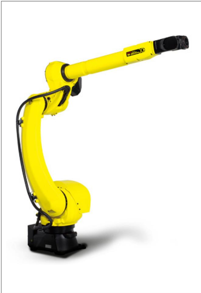
Die Serie M-20 ist in puncto Achsgeschwindigkeit, Nutzlast und Reichweite branchenführend – Sechs Achsen handhaben Nutzlasten bis 35 kg mit einer Reichweite von 2,0 m. Die Serie ist stark und dennoch leicht. Dafür sorgt das außergewöhnliche Design mit hohlem Oberarm und Handgelenk, das keinerlei Kompromisse bei der Leistung eingeht. Der M-20 ist ein Universaltalent zum Materialhandling für mittlere Traglasten.
