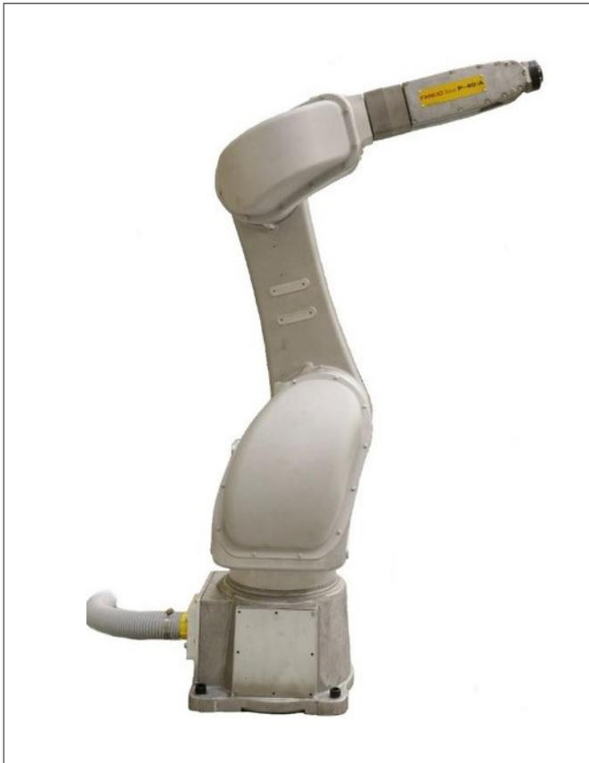
Lackierroboter von FANUC eignen sich für vielfältige Lackier- und Beschichtungsaufgaben und sind leicht zugänglich. Zudem bieten sie optimale Arbeitsräume und maximierten Durchsatz. Modelle für den Einsatz in Gefahrenbereichen stehen ebenso zur Auswahl wie verschiedene Reichweiten und Kapazitäten. Somit ist garantiert für jeden Anwendungsfall ein Modell verfügbar.
