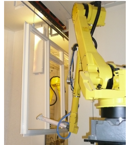
Lackieren nach generiertem Programm
