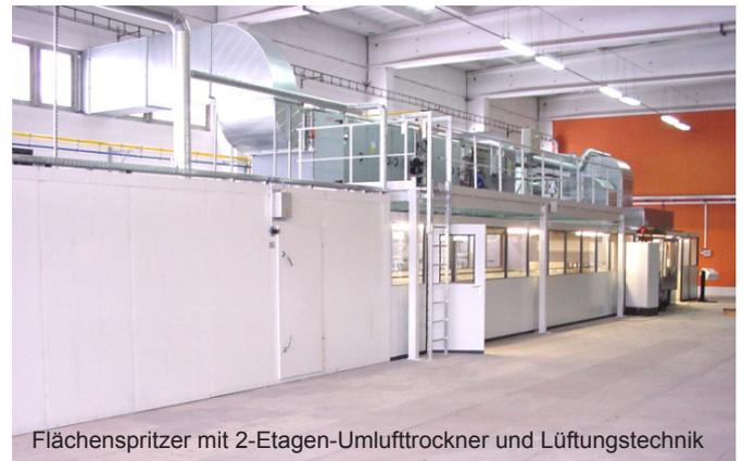
Flächenspritzer mit 2-Etagen-Umlufttrockner und Lüftungstechnik
