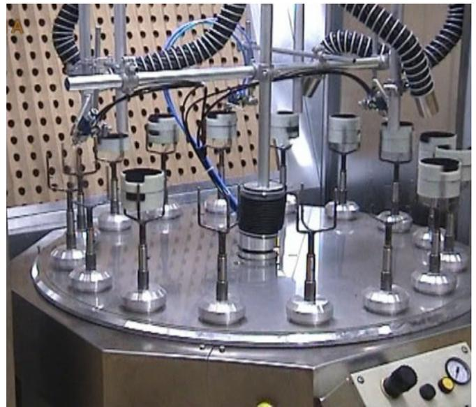
Rundautomaten bieten eine kostengünstige Lösung zur automatischen Beschichtung. Als Kleinautomaten sind sie auch mobil zum Anstellen an vorhandene Spritzkabinen einsetzbar.
