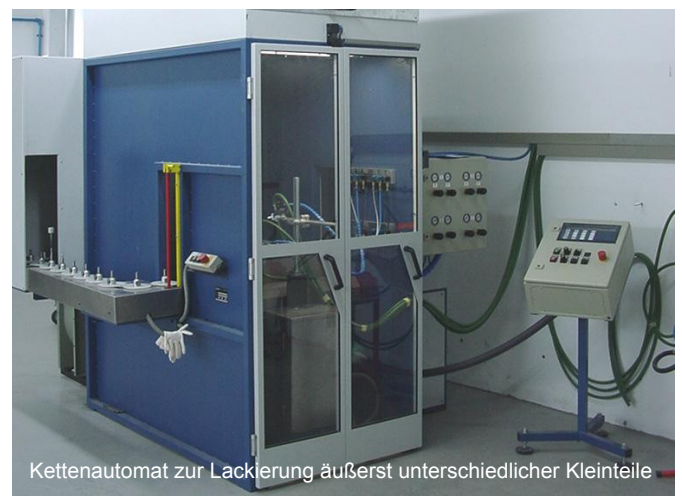
Kettenautomat zur Lackierung von Holz-Drehteilen
