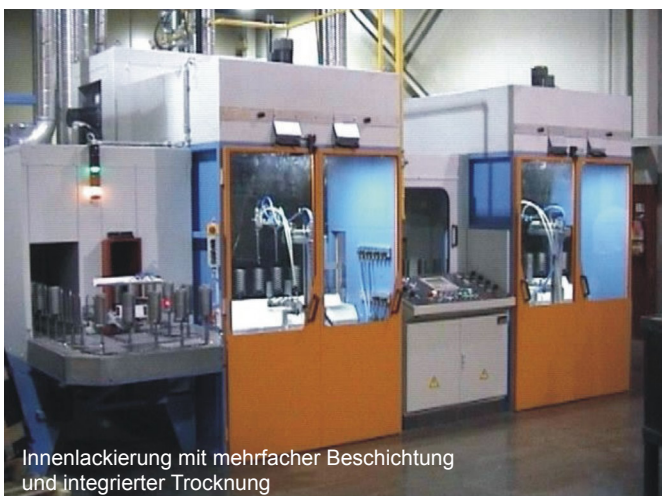
Kettenautomat zur Lackierung äußerst unterschiedlicher Kleinteile
