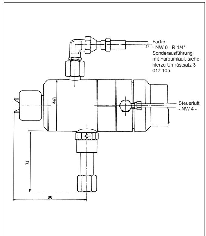
Bei diesem Sprühsystem wird das unter Hochdruck stehende Lackmaterial beim Verlassen der Materialdüse zerstäubt.
