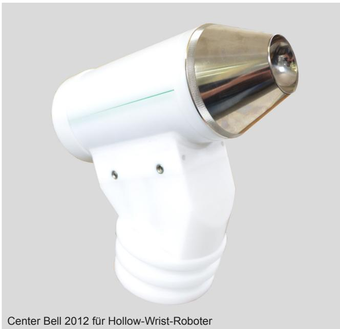
Das Sprühsystem Center Bell 2012 mit Kontaktaufladung ist ein druckluftbetriebenes Hochrotationssprühsystem mit einer sich sehr schnell drehenden Sprühglocke – max. 50.000 min<sup>-1</sup> während der Applikation – an dem Hochspannung angelegt ist.
