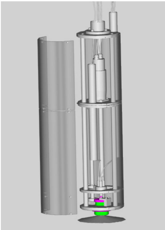
Das Sprühsystem Discomat-E mit Kontaktaufladung ist ein elektrisch betriebenes Hochrotationssprühsystem mit einer sich schnell drehenden Sprühscheibe – max. 10.000  $\text{min}^{-1}$  während der Applikation – an die Hochspannung angelegt ist.
