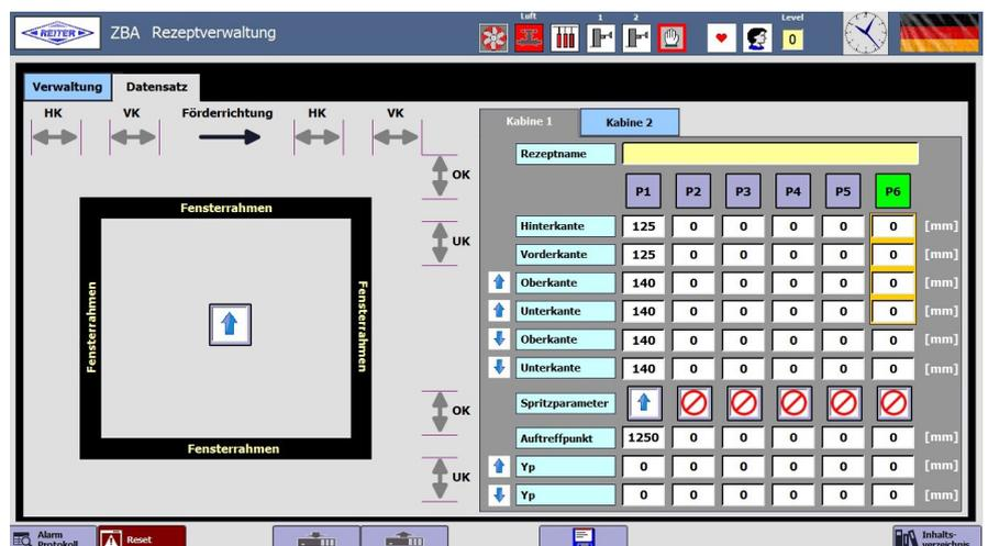
Vergrößerung und Verkleinerung der Werkstücke. Individuelle Einstellung der Pistolenschaltpunkte programmierbar.
