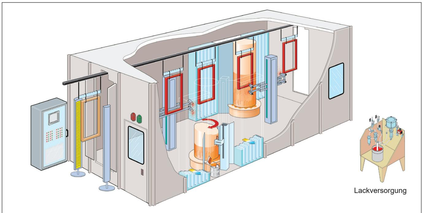
Fensterrahmen in unterschiedlichen Größen und Formen durchlaufen in „chaotischer“ Reihenfolge einen feingerasterten Infrarot-Lichtvorhang am Kabineneinlauf. Hier werden die genauen Konturen der Werkstücke erfasst und an die Steuerung weitergeleitet. Der Rechner koordiniert die gespeicherten Signale mit der Geschwindigkeit des Förderers und der Hubgeräte.
