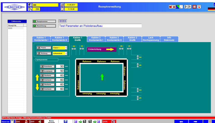
Vergrößerung und Verkleinerung der Werkstücke. Individuelle Einstellung der Pistolenschaltpunkte programmierbar.
