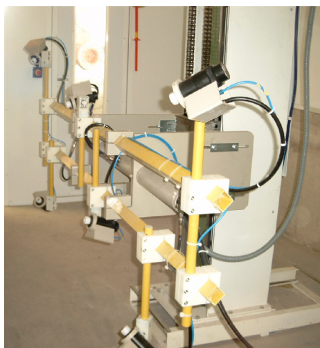
Hubgerät mit isoliertem Sprühsystemaufbau und reproduzierbarer Sprühsystem-Halterung.
