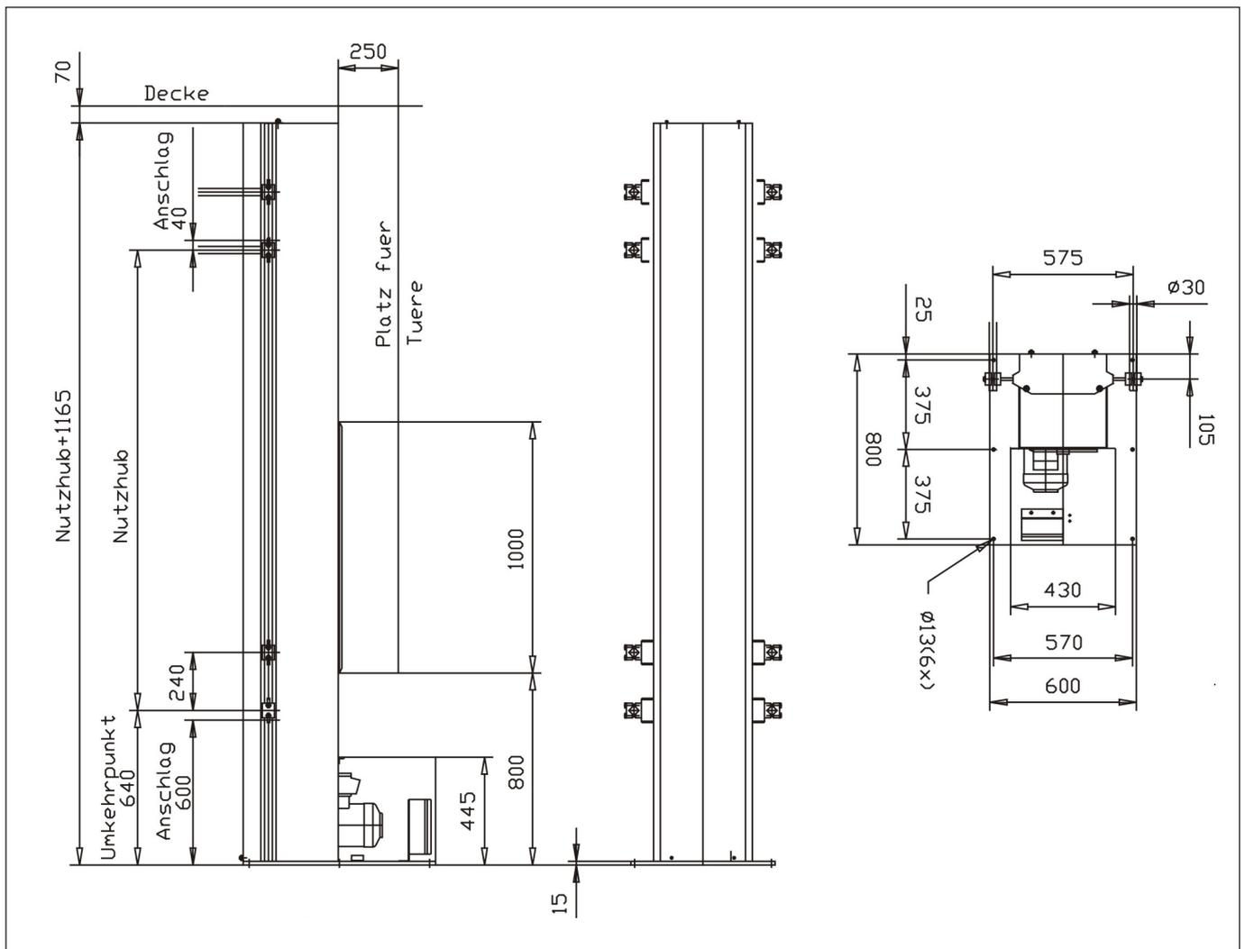
Der Hubschlitten, an dem die Spritzorgane befestigt sind, wird an einer vertikalen Führungsschiene durch Rollen geführt. Das Schlittengewicht, mit den angebaute Spritzorganen, kann durch Anpassung der Gewichte im Gegengewichtschlitten weitestgehend kompensiert werden. Der Antrieb erfolgt durch einen reversierbaren
