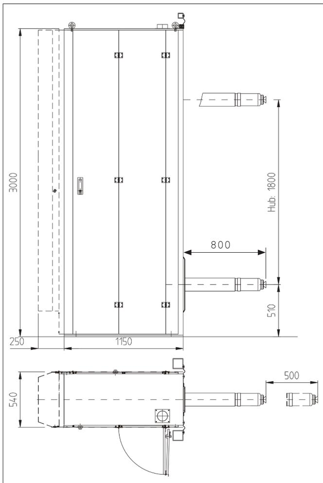
Die 2-/3-Achsen-Maschine wurde konzipiert für den Einbau als außenstehende Maschine in die Kabinenwand. Einsatzgebiete sind vorzugsweise Anlagen mit Hochrotationszerstäuber.
