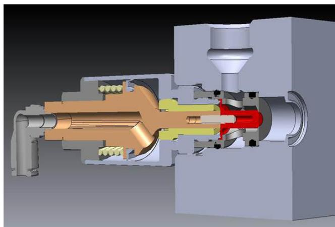
RMV Membranventil im Farbwechselblock
