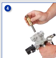
Neue PROXCHANGE™ Pumpe installieren und Pumpensystem einsetzen
