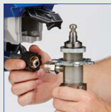
Schlauch und Ansaugrohr abnehmen
