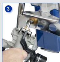
Mit Sechskant-Rahmenfitting die Pumpe lösen und die Patrone entfernen
