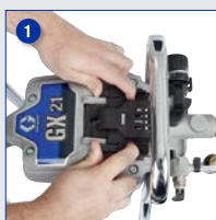
Zugangsabdeckung aufschieben und anheben
